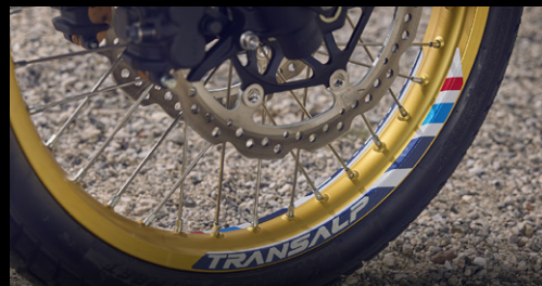
Frenos de disco con ABS que se adapta a cada modo de conducción y con opción de desconexión trasera para off-road
