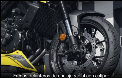
Frenos delanteros de anclaje radial con caliper de 4 pistones y ABS.
